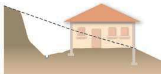
Plate-forme en déblais
